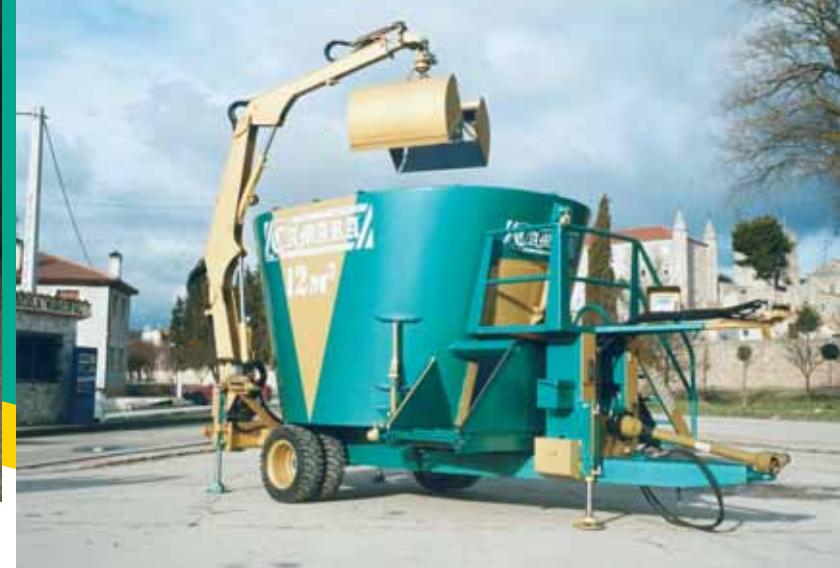
Grua de carga trasera giratoria a 360° 360° rotating loading crane Grua de chargement arrière rotative a 360 degré.
