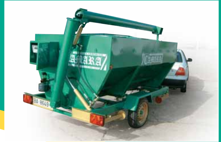
Vagoneta especial para vehículos ligeros. Special wagon for light vehicles Wagonnet spécial pour véhicule léger.
