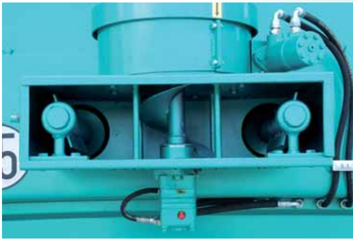
Dos sinfines de arrastre helicoidales hidráulicos para aumentar la capacidad de descarga. Two helicoid hydraulic transport augers in order to increase the unloading capacity. Deux vis sans fin d'entraînement hélicoïdales pour augmenter la capacité de déchargement.
